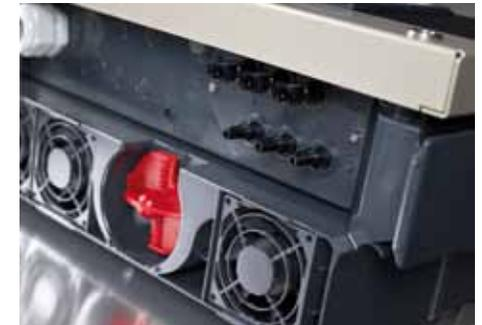
Abb. 20: Wechselrichter mit unterschiedlich ausgeführten, integrierten DC-Freischaltern.
