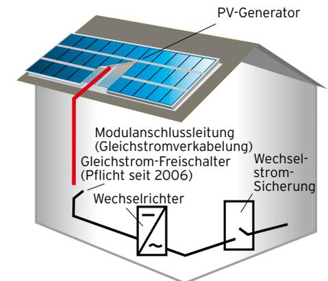
Abb. 23: PV-Anlage (schematisch)
